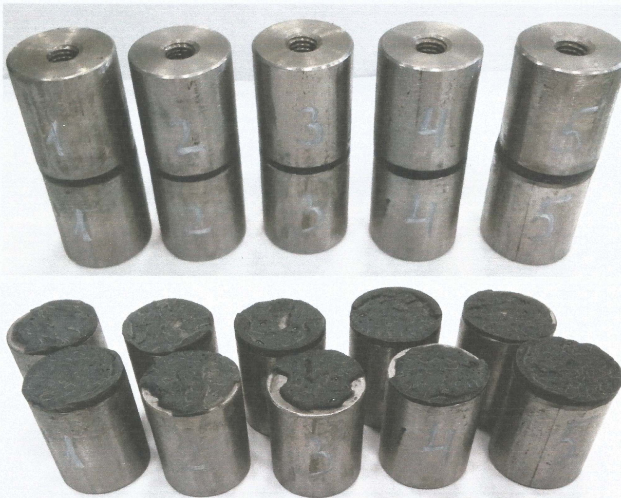
Фотографии образцов 1+5 до и после испытаний
