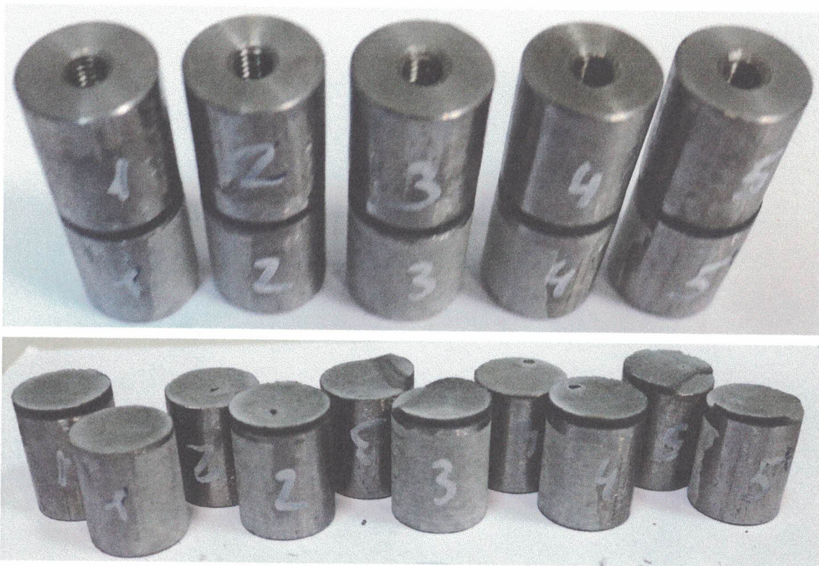
Фотографии образцов 1+5 до и после испытаний
